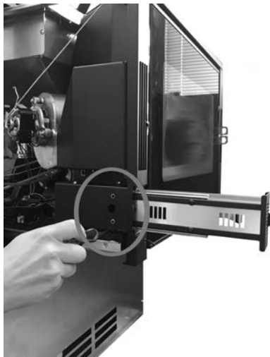
Fig. 90 - Fije los tornillos
