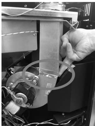
Fig. 54 - Selle con cinta adhesiva de aluminio
