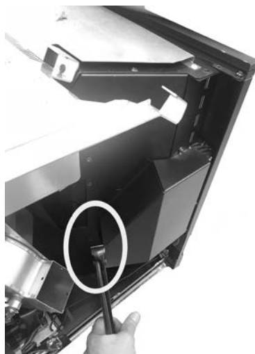
Fig. 46 - Rompa la esquina
