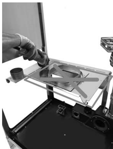
Fig. 67 - Cortar la tapa
