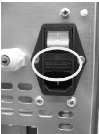
Fig. 106 - Ventanilla con los fusibles de remover
