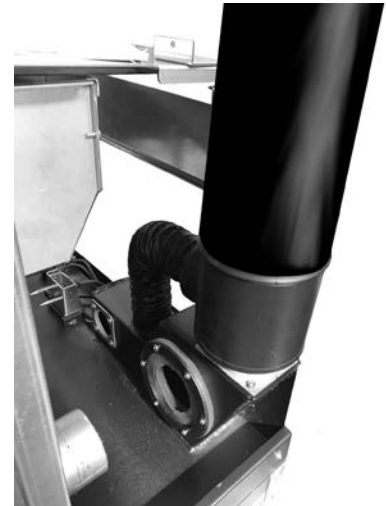
Fig. 85 - Conexión al tubo de salida de humos
