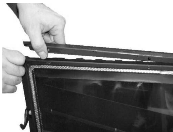
Fig. 105 - Extracción de los perfiles de la puerta
