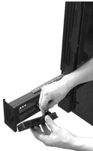
Fig. 91 - Conecte la pantalla y vuelva a colocarla
