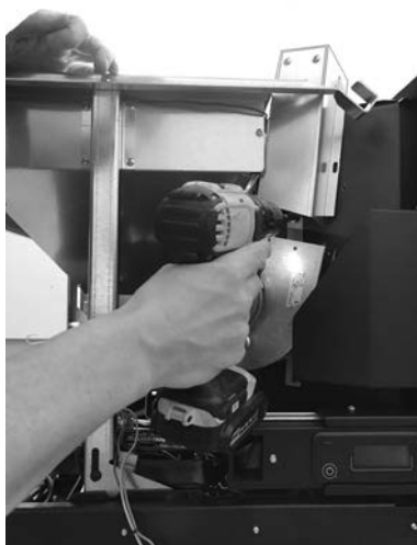
Fig. 52 - Fije el ventilador
